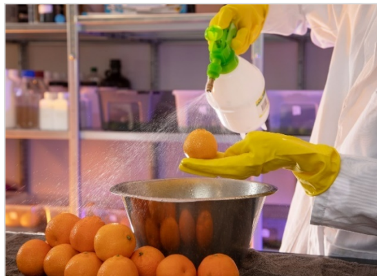
[Foto 4 und 5] Umweltverträgliche Schutzschicht: Die Beschichtungen von Liquidseal werden hauchdünn direkt auf die Schalen, etwa von Orangen, Zitronen, Mangos und Avocados aufgetragen. Liquidseal ist sehr umweltverträglich, zu 100 Prozent biologisch abbaubar und kompostierbar. Eine wichtige Rolle spielen dabei Kurarays hochwertige PVOH-Materialien. (Fotos: Liquidseal)
