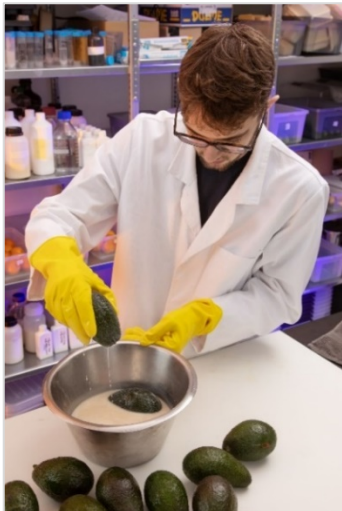
[Foto 4 und 5] Umweltverträgliche Schutzschicht: Die Beschichtungen von Liquidseal werden hauchdünn direkt auf die Schalen, etwa von Orangen, Zitronen, Mangos und Avocados aufgetragen. Liquidseal ist sehr umweltverträglich, zu 100 Prozent biologisch abbaubar und kompostierbar. Eine wichtige Rolle spielen dabei Kurarays hochwertige PVOH-Materialien. (Fotos: Liquidseal)
